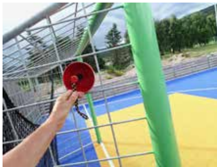
Ulovlig åpning i fast klatrebart nett i målbur.
